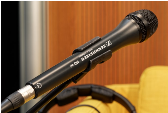
Bei den Podcasts werden die Stimmen von dynamischen Sennheiser-Mikrofonen des Typs MD 46 eingefangen
